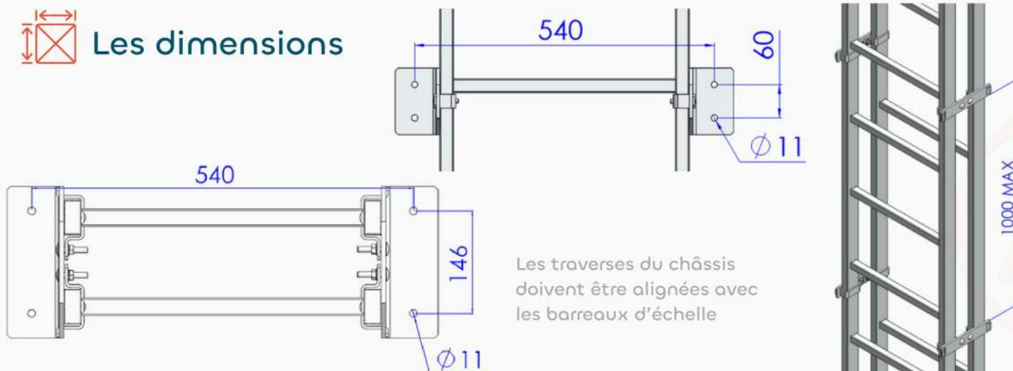
Les traverses du châssis doivent être alignées avec les barreaux d'échelle
