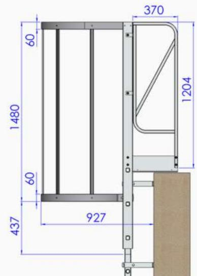
La première fixation doit être installée le plus haut possible sur la sortie (entre les deux derniers échelons)
