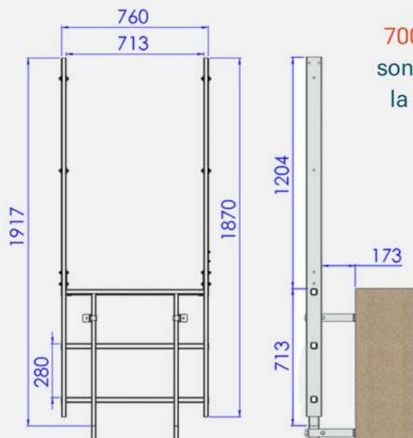
La première fixation doit être installée le plus haut possible sur la sortie (entre les deux derniers échelons)
