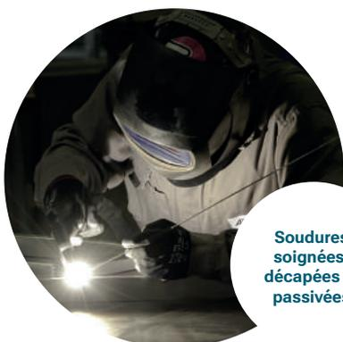
Soudures soignées, décapées et passivées
