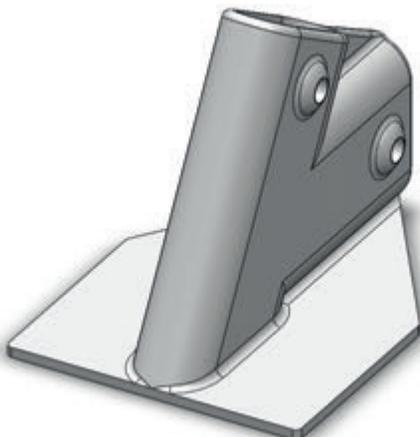
La plinthe est fixé avec une vis de 10x20 qui se visse dans la platine
