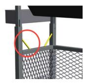
Positionnement des élingues sur les anneaux de levage pour l'acheminement du chariot sur site difficilement accessible (à vide)
