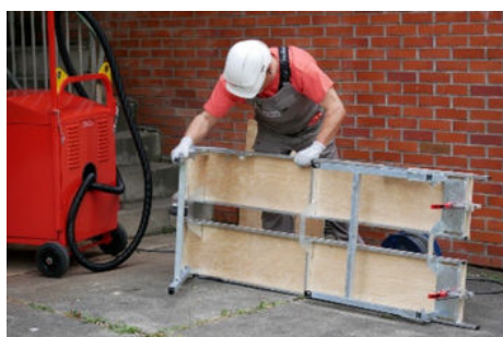
Verrouillage de la table en position fermée
