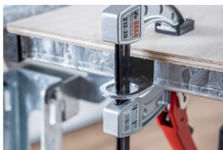
Maintien de la pièce à découper à l'aide des serre-joints
