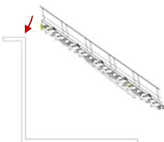
La fixation doit **obligatoirement** être assurée par les **6 trous** des plats de fixation prévus à cet effet.
