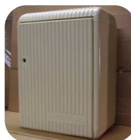
Coffre relais Aluminium Brut Conception mixte tôlerie fonderie Peinture époxy texturée
