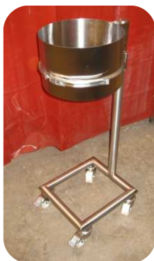
Support Poubelle Inox 304 L brossé grain 220 Soudure meulée, rayonnée avec reprise de grain Finition salle blanche
